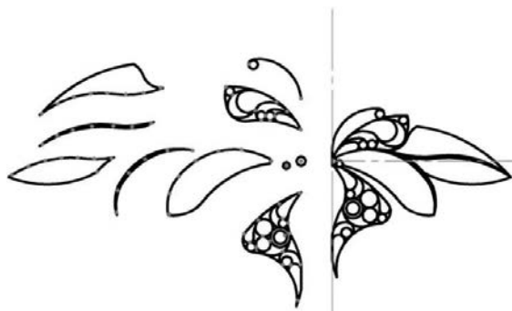
Рисунок 4. Конструкция сборки броши “Somnia” с указанием мест соединения в графическом приложении «КОМПАС-3D»
