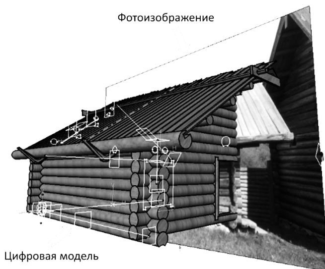
Рисунок 2. Цифровая модель, созданная на основе фотоизображений этнического деревянного строения «Куала» (автор – С. Н. Зыков)
